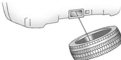
6. Incline la llanta hacia el vehículo dejando algo flojo el cable, para tener acceso al retenedor de la llanta/rueda.
