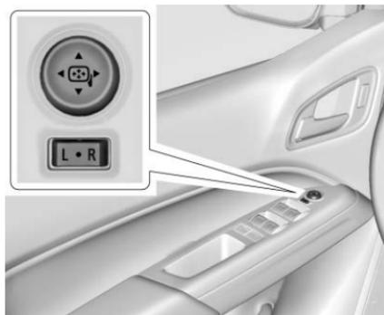
Si está equipado, ajuste los espejos eléctricos.
