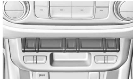
Encienda y apague el Modo de Remolque/Arrastre presionando el botón en la columna central. Cuando el Modo de Remolque/Arrastre está habilitado, se encenderá una luz en el grupo de instrumentos.
