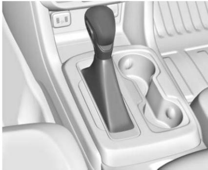
**P** : Esta posición bloquea las ruedas motrices. Utilice P (estacionamiento) al arrancar el motor, ya que el vehículo no puede moverse con facilidad. Cuando se encuentra estacionado en una colina, en particular cuando el vehículo lleva una carga pesada, puede percibir un incremento en el esfuerzo para cambiar fuera de P (estacionamiento). Vea "Bloqueo de torque" en *Cambio a PARK (estacionamiento)* ⇨ 213.
