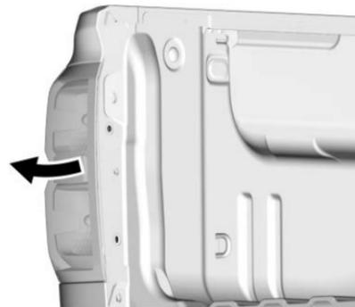
4. Jale el ensamblaje de la luz trasera de forma recta hacia atrás para retirarlo del vehículo.
