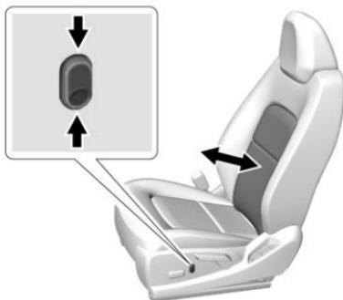
Si está equipado, oprima sin soltar la parte superior del control para aumentar el soporte lumbar. Mantenga presionada la parte inferior del control para disminuir el soporte lumbar. Suelte el control cuando el respaldo alcance el nivel deseado de ajuste de soporte lumbar.
