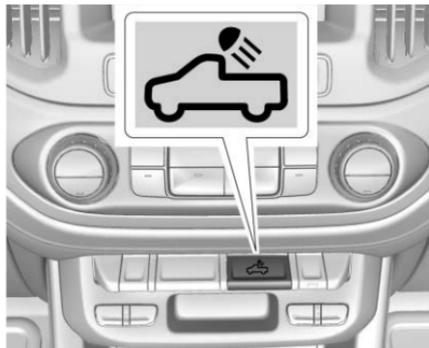
Las luces de carga exterior proveen más luz en el área de carga del vehículo, si se requiere. Las luces dentro de la caja pickup, la manija de la puerta trasera, el gancho, y las luces del espejo de carga también se encienden, si están equipadas.
