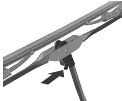
2. Presione la palanca de liberación en el centro de la hoja del limpiaparabrisas donde se fija la hoja del limpiaparabrisas.
