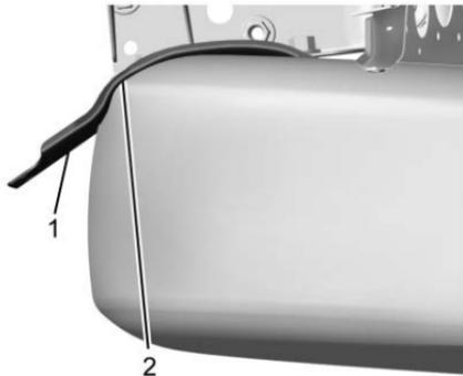
7. Asegúrese de que la llanta esté guardada con seguridad y al ras en el radio (2) de la ménsula de soporte (1) de la llanta de refacción. Empuje, jale la llanta y después trate de girarla. Si la llanta se mueve, use la llave para las ruedas para apretar el cable.
